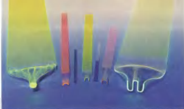
Световоды. Яркий торец — результат сбора света
